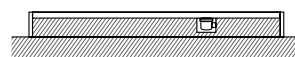
Semiempotrado con un murete de obra À demi encastré avec muret Wedged in the wall Eingebaut mit einer Mauer
